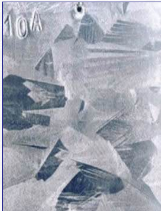
Bề mặt sản phẩm mạ kẽm vân hoa Surface of galvanized products with floral pattern
